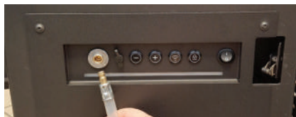
Rys. 21 Presa di alimentazione della pompa esterna con la spina corrispondente della pompa esterna
