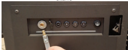
Rys. 21 Prise d'alimentation de la pompe externe avec la fiche correspondante provenant de la pompe externe
