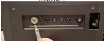
Rys. 21 Stromversorgungsbuchse der externen Pumpe zusammen mit dem passenden Stecker der externen Pumpe
