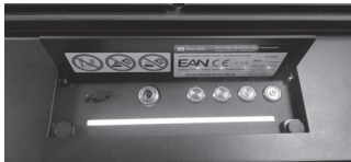
Abb. 9-52 LED-Streifen während des Zündvorgangs des Geräts
