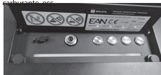
Fig. 9-54 Indicazione di circa il 5% di carburante nel serbatoio.
