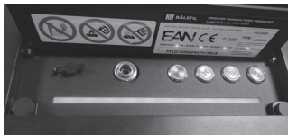
Abb. 9-55 LED-Streifen nach Erkennung der nicht erfüllten Sicherheitsbedingungen
