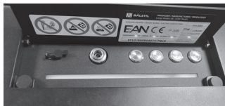
Abb. 9-54 Anzeige von etwa 5 % Brennstoff im Tank
