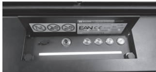
Rys. 9-52 Pasek LED w trakcie rozpalania urządzenia
