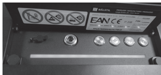
Rys. 9-55 Pasek LED po wykryciu niespełnionych warunków bezpieczeństwa
