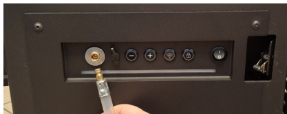
Rys. 21 Presa di alimentazione della pompa esterna con la spina corrispondente della pompa esterna
