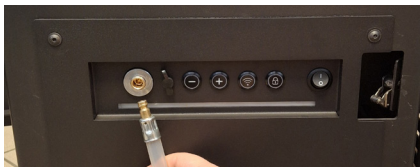
Fig. 20 Connettore rapido per il rifornimento del combustibile con il connettore corrispondente della
