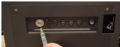
Rys. 20 Schnellkupplung des Brennstoffeinfüllstutzens zusammen mit dem passenden Anschluss der externen Pumpe
