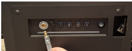
Rys. 20 Szybkozłączce wlewu paliwa wraz z pasującym złączcem pompy zewnetrznej
