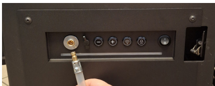
Rys. 21 Gniazdo zasilania pompy zewnetrznej wraz z pasującą wtyczką z pompy zewnetrznej
